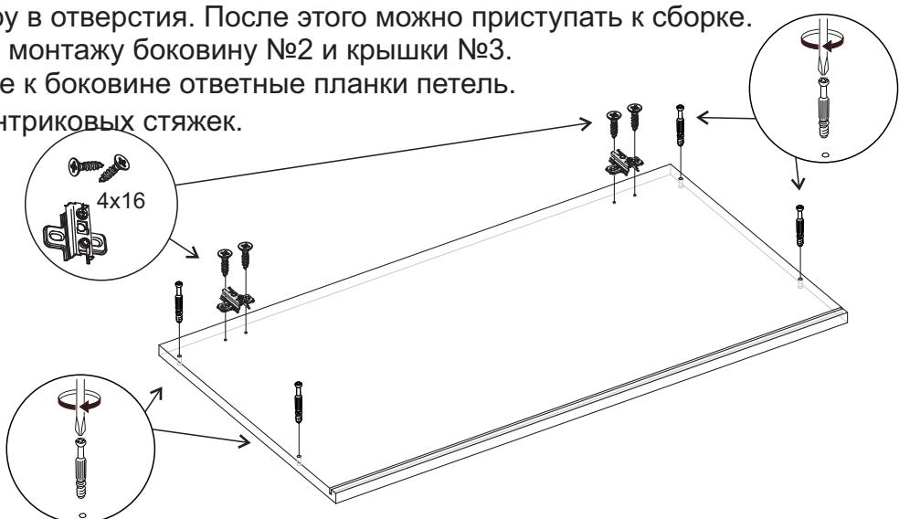
3. Закрепите с помощью эксцентриковых стяжек к нижней крышке №3 боковины №2, затем вставьте в паз заднюю стенку №1 (ЛХДФ) предварительно прорезав отверстия для регулируемых навесов.
