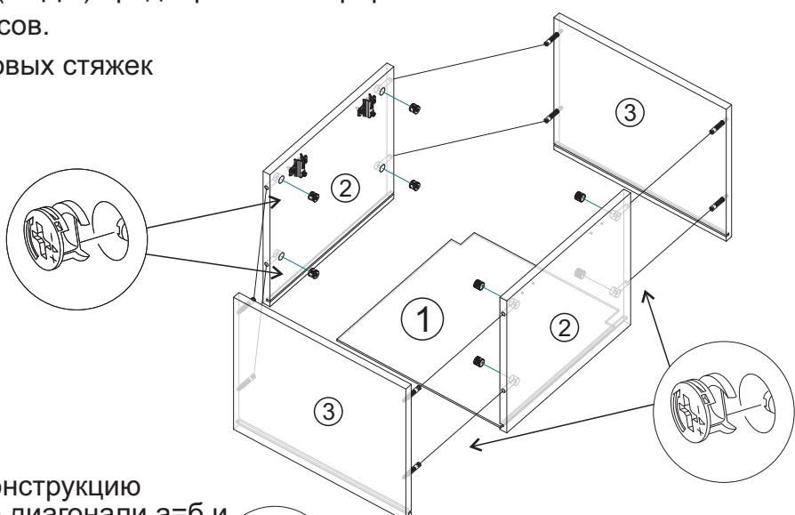
4. Переверните собранную конструкцию лицевой стороной вниз, уравняйте диагонали а=б и аккуратно не нарушая диагоналей закрепите заднюю стенку №1 к боковинам и крышкам с помощью уголков RV8 и шурупов 4x16.
