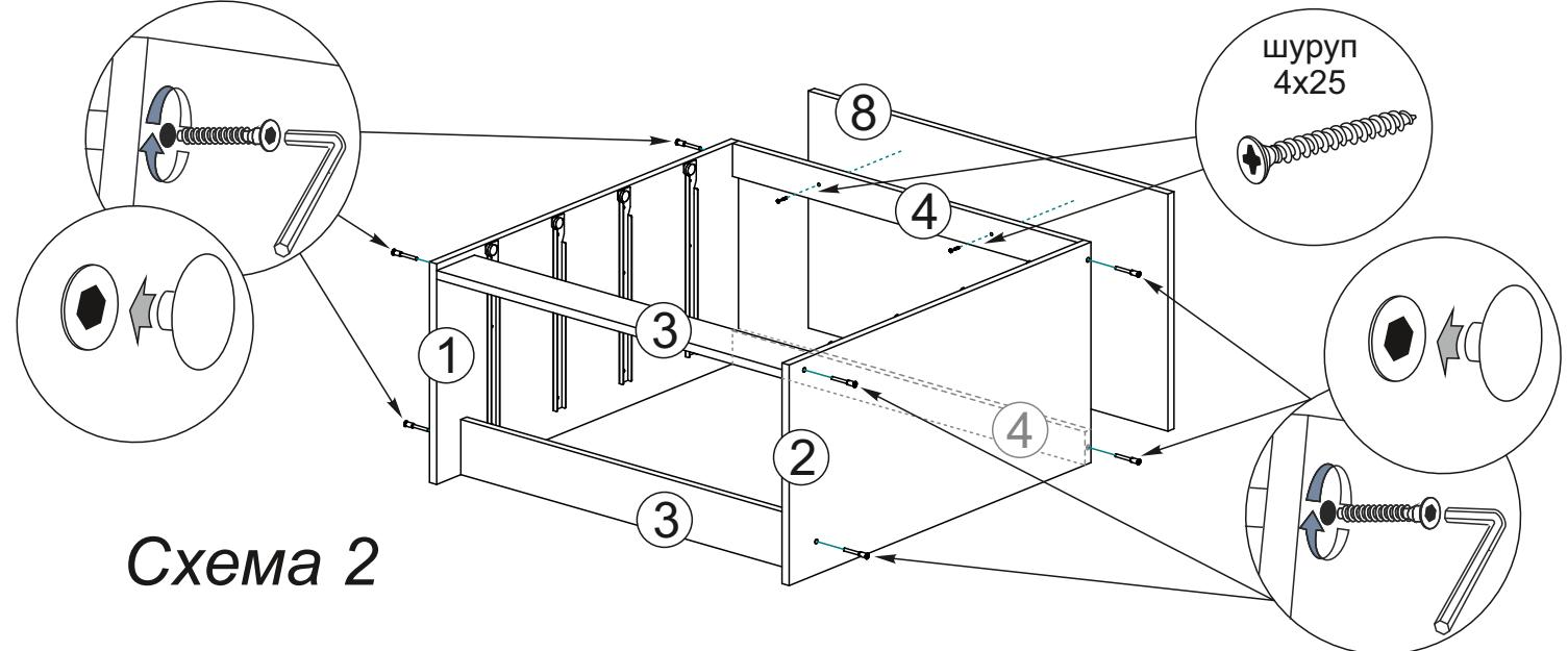
4. Чтобы установить задние стенки (детали №10), необходимо собранную конструкцию перевернуть лицевой стороной вниз. Замерить, с помощью рулетки, и уравнять диагонали ( $a=b$ ). Наложить задние стенки, проложив между ними соединительный брус. Аккуратно, не нарушая диагоналей, прибить ЛДВП гвоздями, шагом 130-150 мм., как показано на схеме 3
