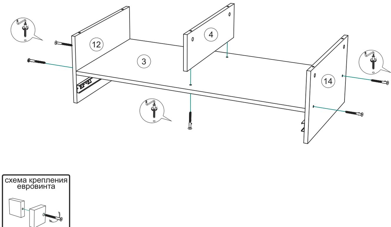
3. Соберите корпус тумбы. Для этого соедините евровинтами крышку №13 с боковинами №10 и №11 и перегородкам №12 и №14. Вставьте в пазы заднюю стенку ДВП №1. Закрепите крышку №9 к боковинам и перегородкам при помощи эксцентриковых стяжек, прикрутите опоры шурупами 4x30, установите уголки Rv8 на заднюю стенку №1 при помощи шурупов 4x16, как показано на схеме 3.
